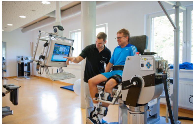
Isokinetischer Muskelfunktionstest zur Ermittlung der Kraftverhältnisse ▼
